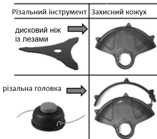
Рисунок 4. Комбінації використання різального інструменту із захисним кожухом.
