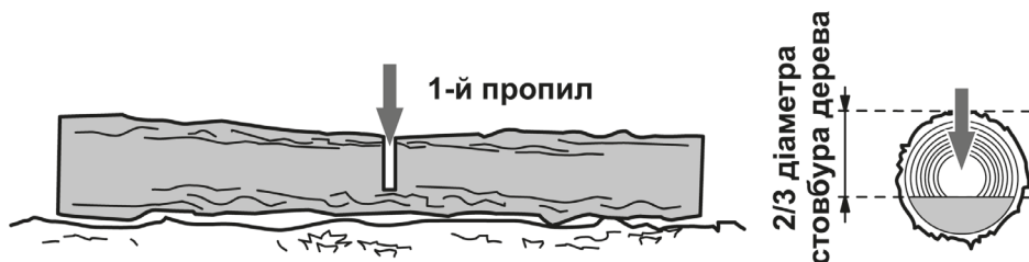
Рисунок 13. Схема попереднього розпилу колоди.
