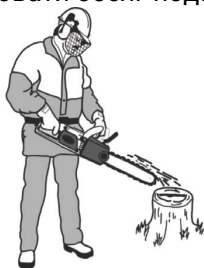
Рисунок 5. Схема перевірки системи подачі мастила.
