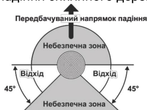
Рисунок 11. Схема зони падіння дерева.
