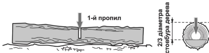
Рисунок 12. Схема попереднього розпи́лу колоди.
