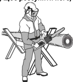
Рисунок 14. Схема розпилу колоди з використанням козлових опор.
