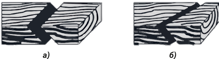
Рисунок 4. Приклад різу торця під кутом до вертикалі поперек (а) дошки та під кутом у горизонтальній площині (б).
