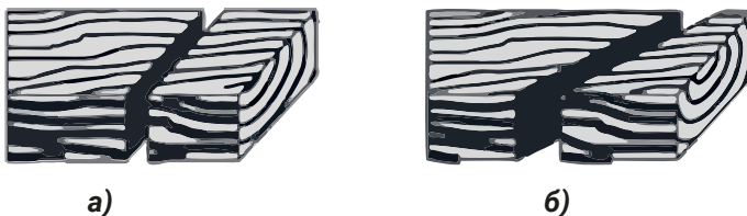
Рисунок 3. Приклад різі торця заготовки перпендикулярно поверхні заготовки поперек (а) дошки та під кутом у горизонтальній площині (б).
