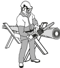
Рисунок 6. Схема розпилу колоди з використанням козлових опор.
