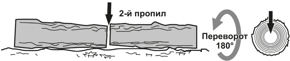
Рисунок 5. Схема остаточного розпилу колоди з протилежного боку.
