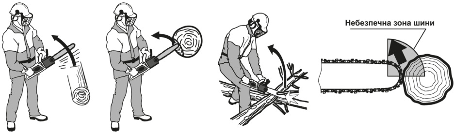
Рисунок 2. Приклади виникнення небезпечної віддачі виробу.
