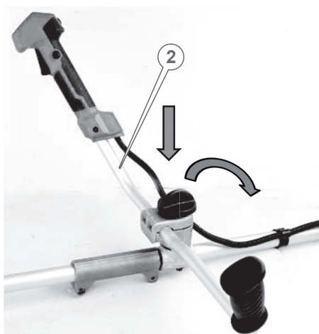
Рисунок 5. Схема приєднання руків'я до штанги електрокоси.
