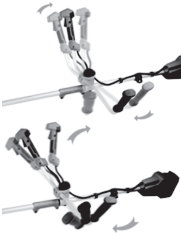
Рисунок 7. Схема регулювання кута нахилу руків'я.
