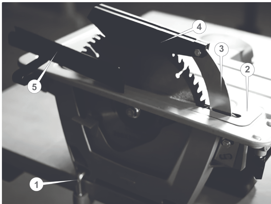
Рисунок 6. Схема встановлення виробу для стаціонарної роботи у перевернутому стані.
